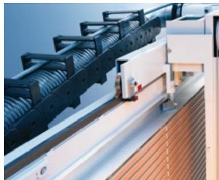
Una solución técnicamente eficaz y precisa: la cadena de cables de la STANDARD.
