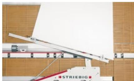
El accesorio para cortar ángulos WSG se puede posicionar a la izquierda o a la derecha de cualquier corte vertical. Su montaje es fácil y rápido. La escala graduada integrada permite ajustar progresivamente la longitud deseada de la pieza.
