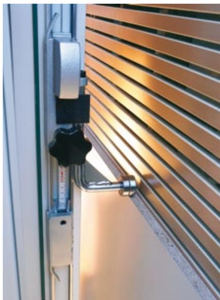
El tope para tiras montado de serie, con soporte de rodillos que protege los cantos, facilita la realización de cortes repetidos.
