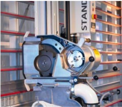
Los trabajos de acanalado y fresado son absolutamente imprescindibles en muchos pedidos. Con la STANDARD, estos trabajos pueden realizarse sin problemas. Puede trabajar materiales de madera y tableros de unión.
